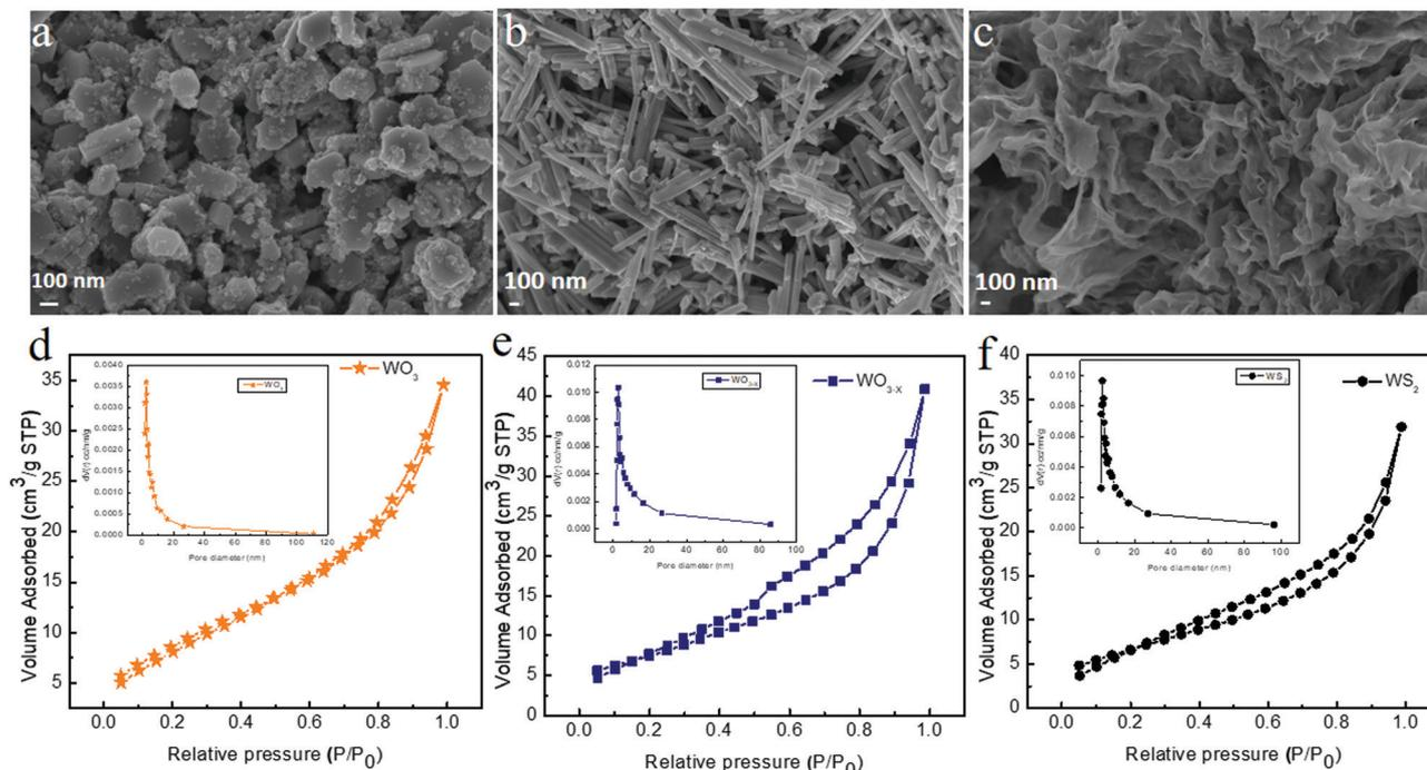
Fig. 4 FESEM images of (a)  $\text{WO}_3$ , (b)  $\text{WO}_{3-x}$  and (c)  $\text{WS}_2$ , and nitrogen adsorption and desorption isotherms of (d)  $\text{WO}_3$ , (e)  $\text{WO}_{3-x}$  and (f)  $\text{WS}_2$ .
