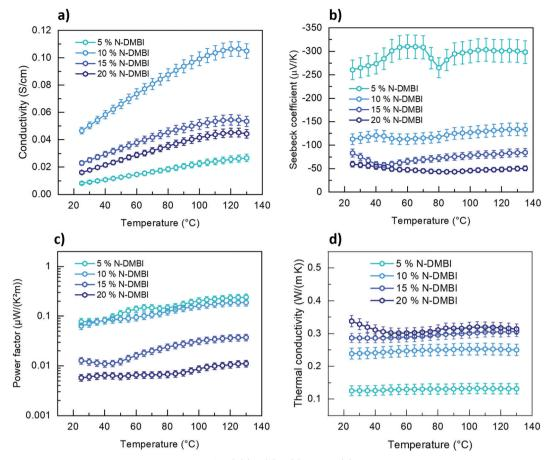
Fig. 5 Temperature-dependent thermoelectric parameter of P1G (a)  $\sigma$ , (b) lpha, (c) PF, and (d)  $\kappa_{\parallel}$ .
