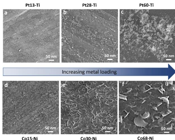
Fig. 3 SEM images of (a) Pt13-Ti, (b) Pt28-Ti, (c) Pt60-Ti, (d) Co15-Ni, (e) Co30-Ni, and (f) Co68-Ni electrodes.
