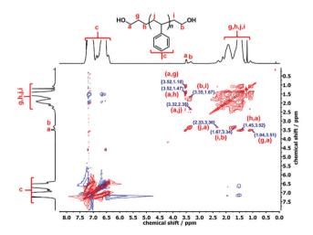
Fig. 4 TOCSY NMR spectrum of l-PS-4k (CDCl<sub>3</sub>, 25 °C, 600 MHz).
