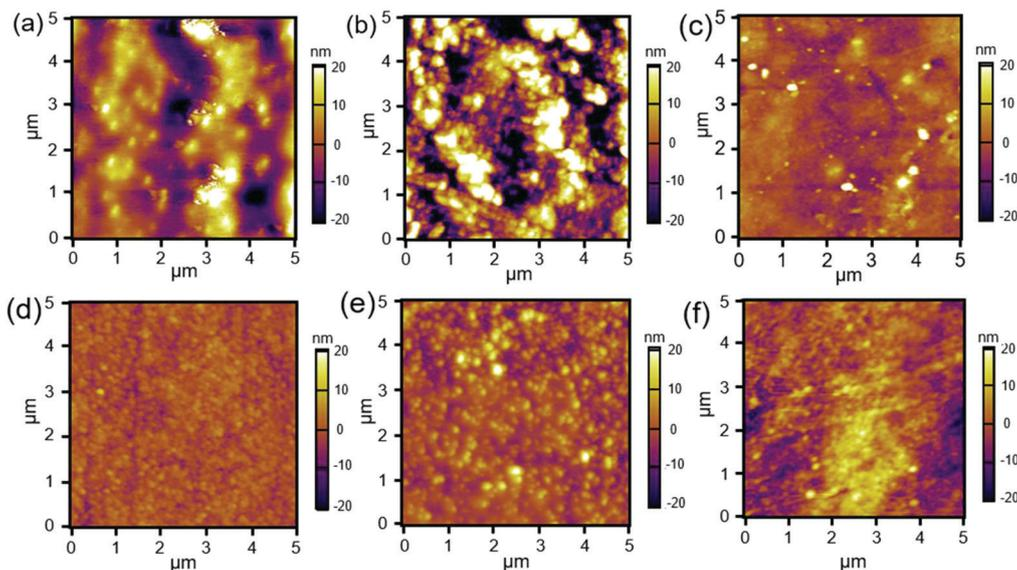
Fig. 3 AFM height micrographs of (a)  $\text{SF}_{\text{EO}}$ , (b)  $\text{SF}_{\text{EO-zwitter}}$ , (c)  $\text{SF}_{\text{EO-PEG}}$ , (d)  $\text{SF}_{\text{OX}}$ , (e)  $\text{SF}_{\text{OX-zwitter}}$ , and (f)  $\text{SF}_{\text{OX-PEG}}$  film surfaces.
