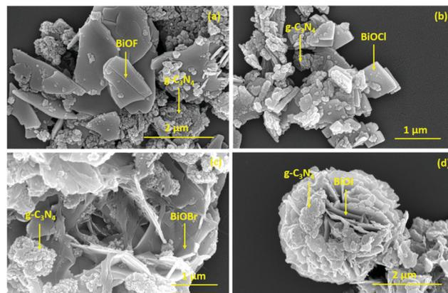
Fig. 4 FESEM images of (a)  $\text{BiOF}/g\text{-C}_3\text{N}_4$ , (b)  $\text{BiOCl}/g\text{-C}_3\text{N}_4$ , (c)  $\text{BiOBr}/g\text{-C}_3\text{N}_4$  and (d)  $\text{BiOI}/g\text{-C}_3\text{N}_4$  composites.
