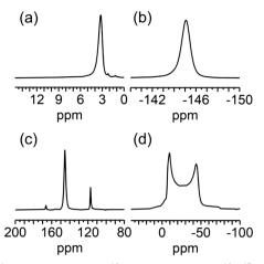
Fig. 2 (a) <sup>1</sup>H DE-MAS-NMR, (b) <sup>19</sup>F DE-MAS-NMR, (c) <sup>19</sup>F-<sup>13</sup>C CP-MAS-NMR, and (d)  $^{27}$ Al DE-MAS-NMR spectra of F<sub>4</sub>-MIL-53(Al).
