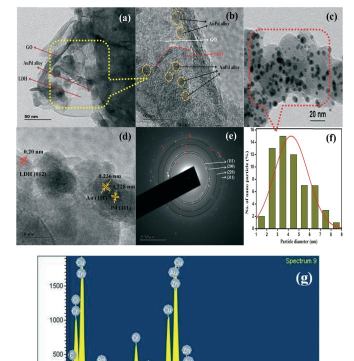
Fig. 3 (a-c) TEM and (d) HRTEM images, (e) an SAED pattern, (f) the particle size distribution and (g) the EDX spectrum of the GO/LDH@AuPd nanocomposite.
