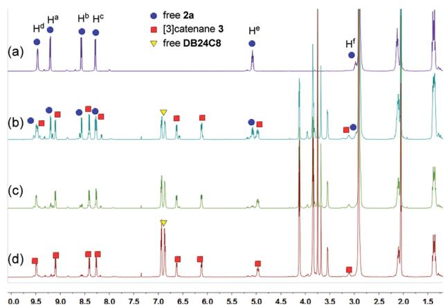
**Fig. 4**  $^1\text{H}$  NMR (500 MHz, acetone- $d_6$ , 25 °C) spectra of metallacycle **2a** (3.0 mM) (a), **2a** (3.0 mM) + DB24C8 (6.0 mM) (b), **2a** (3.0 mM) + DB24C8 (12.0 mM) (c), and **2a** (3.0 mM) + DB24C8 (18.0 mM) (d).
