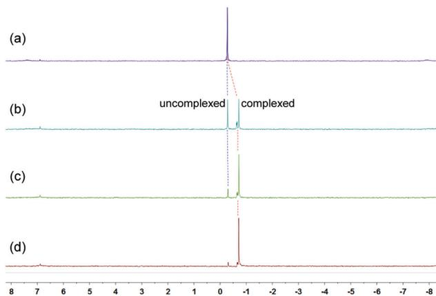
**Fig. 3**  $^{31}\text{P}\{^1\text{H}\}$  NMR (202 MHz, acetone- $d_6$ , 25 °C) spectra of metallacycle **2a** (3.0 mM) (a), **2a** (3.0 mM) + DB24C8 (6.0 mM) (b), **2a** (3.0 mM) + DB24C8 (12.0 mM) (c), and **2a** (3.0 mM) + DB24C8 (18.0 mM) (d).
