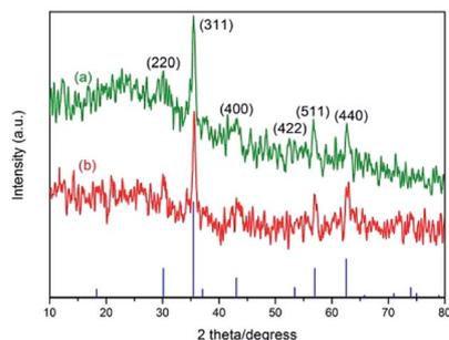
Fig. 4 XRD patterns of (a)  $\text{Fe}_3\text{O}_4@\text{SiO}_2$  and (b)  $\text{NH-Cu(II)@MNP}$  catalyst **3**.
