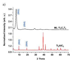
Fig. 2 (a) XRD of ML- $Ti_3C_2T_z$  MXene. (b) SEM of ML- $Ti_3C_2T_z$  MXenes.
