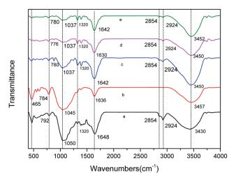
Fig. 1 FTIR of various CMB prepared under different conditions. (a)  $CMB_{200}$ ; (b)  $CMB_{800}$ ; (c)  $CMB_{200-80}$ ; (d)  $CMB_{200-180}$ ; (e)  $CMB_{200-180-w}$ .
