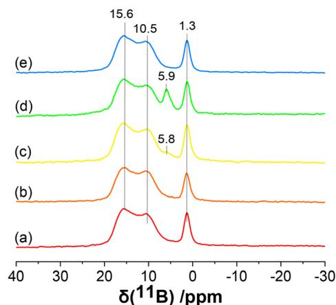
Fig. 3 <sup>11</sup>B MAS NMR of (a) Al<sub>2</sub>O<sub>3</sub>-NaBH<sub>4</sub>(C) control, (b) Pd<sub>3</sub>/Al<sub>2</sub>O<sub>3</sub>-NaBH<sub>4</sub>(A), (c) Pd<sub>3</sub>/Al<sub>2</sub>O<sub>3</sub>-NaBH<sub>4</sub>(B), (d) Pd<sub>3</sub>/Al<sub>2</sub>O<sub>3</sub>-NaBH<sub>4</sub>(C) and (e) Pd<sub>3</sub>/Al<sub>2</sub>O<sub>3</sub>-LiBH<sub>4</sub>(B).
