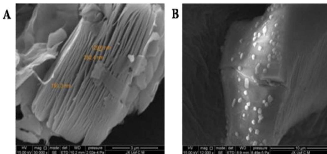
Fig. 7 SEM images of (A) pristine  $\text{Ti}_3\text{C}_2$  and (B)  $\text{Ti}_3\text{C}_2\text{-SO}_3\text{H}$ .<sup>78</sup>
