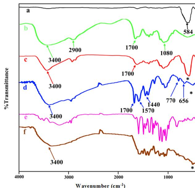
Fig. 2 FTIR spectra of (a)  $\text{Fe}_3\text{O}_4$ , (b) chitosan, (c)  $\text{Fe}_3\text{O}_4$ @CS, (d)  $\text{Fe}_3\text{O}_4$ @CS/UIO-66- $\text{NH}_2$ (Zr), (e) pantoprazole, (f) PNT- $\text{Fe}_3\text{O}_4$ @CS/UIO-66- $\text{NH}_2$ (Zr).
