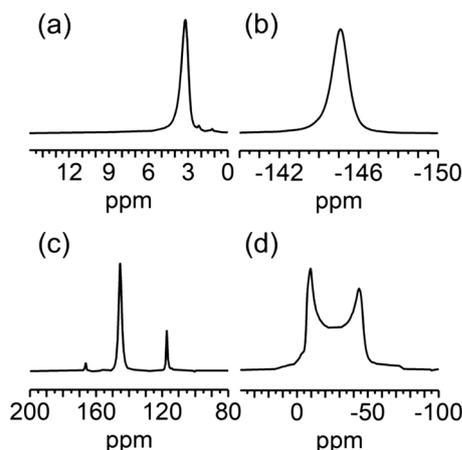
Fig. 2 (a)  $^1\text{H}$  DE-MAS-NMR, (b)  $^{19}\text{F}$  DE-MAS-NMR, (c)  $^{19}\text{F}$ - $^{13}\text{C}$  CP-MAS-NMR, and (d)  $^{27}\text{Al}$  DE-MAS-NMR spectra of  $\text{F}_4\text{-MIL-53(Al)}$ .
