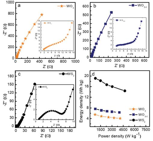
Fig. 8 Nyquist plot of (a)  $WO_{3}$ , (b)  $WO_{3-x}$  and (c)  $WS_2$ , and (d) Ragone plot.
