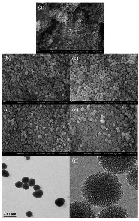
Fig. 2 SEM images of HBPS-NH<sub>2</sub> (a), HBPS-Ph (b), HBPS-COOH (c), HBPS- $C_6H_{13}$  (d) and HBPS- $\beta$ -CD (e) and TEM images of HBPS (f and g).
