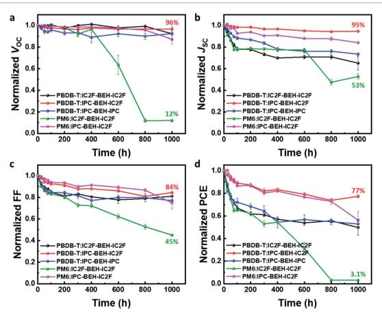
Fig. 8 Long-term stability data of the OSC devices: (a)  $V_{\rm OC}$ , (b)  $J_{\rm SC}$ , (c) FF, and (d) PCE.
