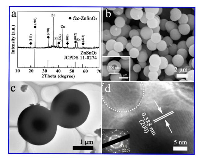
Fig. 8 (a) XRD pattern, (b) SEM image, (c) TEM image, and (d) HRTEM image of ZnSnO $_3$  hollow microspheres. $^{90}$
