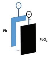
$Pb + PbO_2 + 2H_2SO_4 \longrightarrow 2PbSO_4 + 2H_2O$
