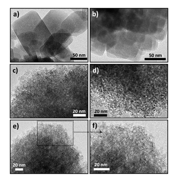
**Figure 3**. TEM micrographs of the ZSM-5 samples: a) ZSM-5, b) ZSM-5 (mnt), c) h-ZSM-5 and d), e) and f) h-ZSM-5 (mnt).
