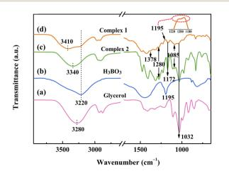
Fig. 3 FTIR spectra of (a) glycerol, (b)  $H_3BO_3$ , (c) Complex 2, and (d) Complex 1.
