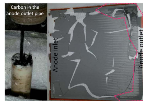
(d) Anode outlet pipe and anode after experiment.
