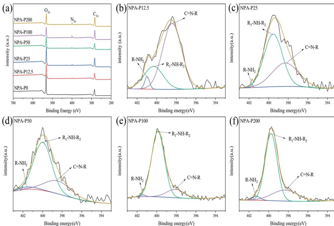
Fig. 2 (a) XPS spectra of NPAs, N<sub>1s</sub> high-resolution spectrum of (b) NPA-P12.5, (c) NPA-P25 (d) NPA-P50 (e) NPA-P100 (f) NPA-P200.
