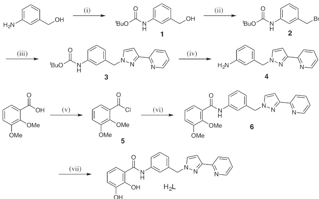
**Scheme 2** Synthesis of  $H_2L$ , (i)  $Boc_2O$ , THF; (ii)  $CBr_4$ ,  $PPh_3$ , THF; (iii) 3-(2-pyridyl)-1H-pyrazole,  $NaOH_{(aq)}$ , THF; (iv) trifluoroacetic acid,  $CH_2Cl_2$ ; (v)  $SOCl_2$ , DMF; (vi) **4**,  $CH_2Cl_2$ ,  $Et_3N$ ; (vii)  $BBr_3$ ,  $CH_2Cl_2$ ,  $H_2O$ .
